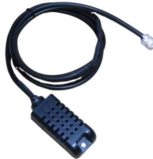
O dispositivo é conectado ao módulo remoto **STRATA-L102** via conector RJ11 e permite a instalação de até 3 sensores por módulo, possibilitando medições em múltiplos pontos (superior, intermediário e inferior) para melhor análise térmica. Use cabo de extensão e *splitters* RJ11 para montar a série com mais de um sensor.
