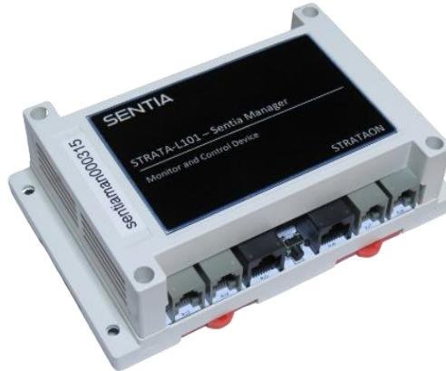
A comunicação com o servidor é realizada via rede Ethernet IP, utilizando o protocolo MQTT, com suporte a TLS para segurança criptografada. Com os módulos **STRATA-L102**, a comunicação é feita através de rede RS-485 com velocidade configurável.
