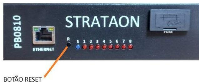
O módulo conta com um botão de reset que permite a reinicialização do módulo para as configurações de fábrica.
