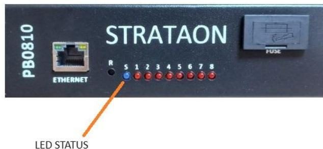
O led STATUS fornece informações sobre o estado geral da comunicação do equipamento. A cada dois segundos é iniciada uma série de até quatro piscadas rápidas. Quando forem contadas quatro piscadas em cada ciclo a situação está normal. Na série de piscadas o significado de cada uma é o seguinte:
